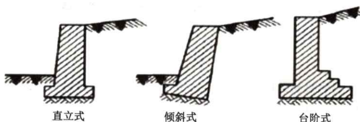
图 3-9 重力式挡土墙
